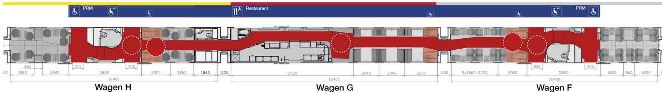
Durchgehender Zugang zum kompletten Restaurant und den PRM-Zonen der 1. und 2. Klasse. Mehr als 40 Meter Rollstuhlzone am Stück mit Wendemöglichkeiten für Rollstuhlfahrer an allen kritischen Punkten.
